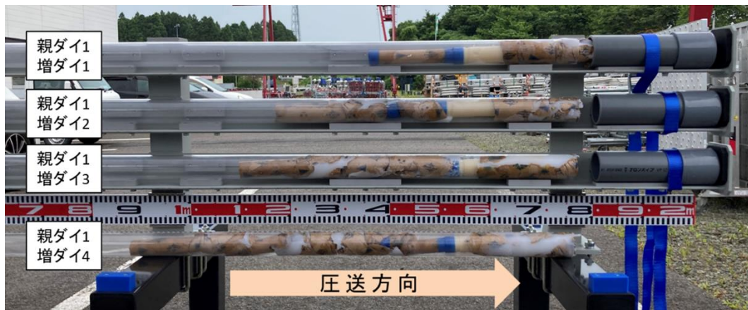
写真1 爆薬装填状況(装薬孔を模したパイプ内に模擬爆薬を圧送)
