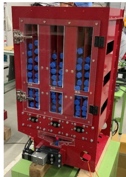
写真6 親ダイをホッパーに格納した状況
