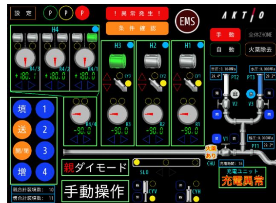
図2 制御 PLC モニター(左:通常稼働状況、右:異常状態 例:充電異常)
